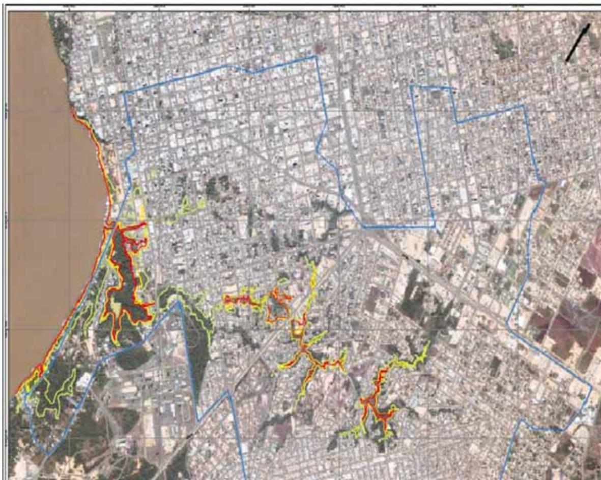
**Figura 2.9.** Área de Risco de Inundação da cidade de Porto Velho **Legenda:** — Bacia do Igarapé Grande; — Alto de risco de inundação; — Médio risco de inundação; — Baixo risco de inundação.
