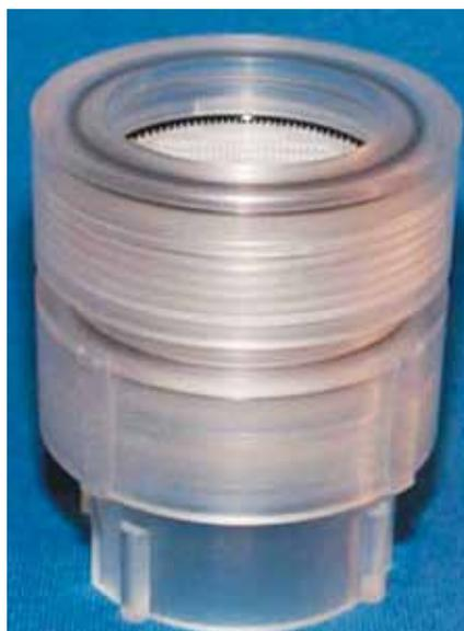
Figura 5.3. Amostrador de particulado fino e grosso (AFG).
