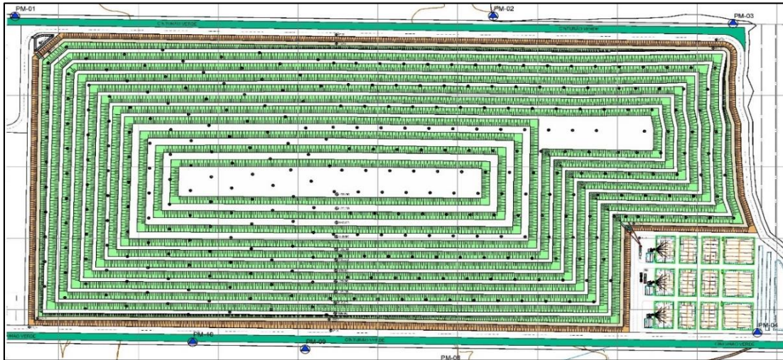
Figura 1. Arranjo final do aterro sanitário - cota 155,0 m.
